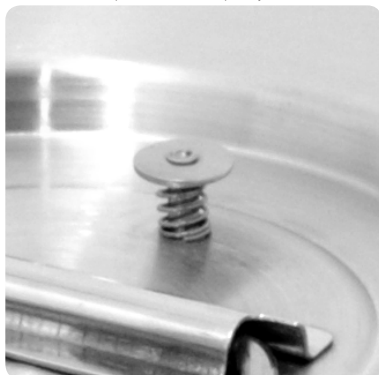
odpowietrznik w pokrywie
